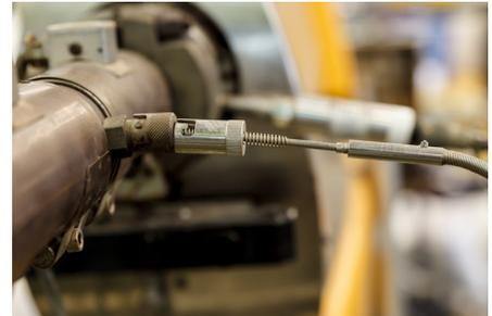
Abb. 10 Temperaturmessung mit Thermoelement
