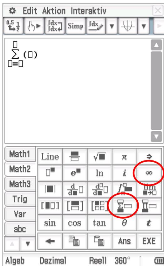
Danach werden die Platzhalter ausgefüllt. Die Buchstaben für die Laufvariable befinden sich im Tastensatz **Var**.
